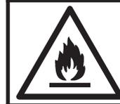
用於機體的隔熱材料發泡劑含有易燃氣體環戊烷。請記住這一點，確處置冷藏櫃/冷凍櫃。
