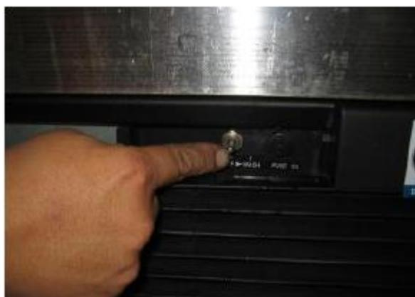
4. 黑色塑膠材質的控制面板兩側凸出之扣耳，用手指向中間按壓並往身體方向拉開(可一次開一邊)
